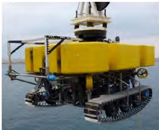
Engin de water-jetting (Crédit photo Rte)
