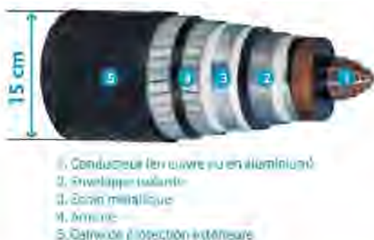
Schéma de principe d'un câble sous-marin.
