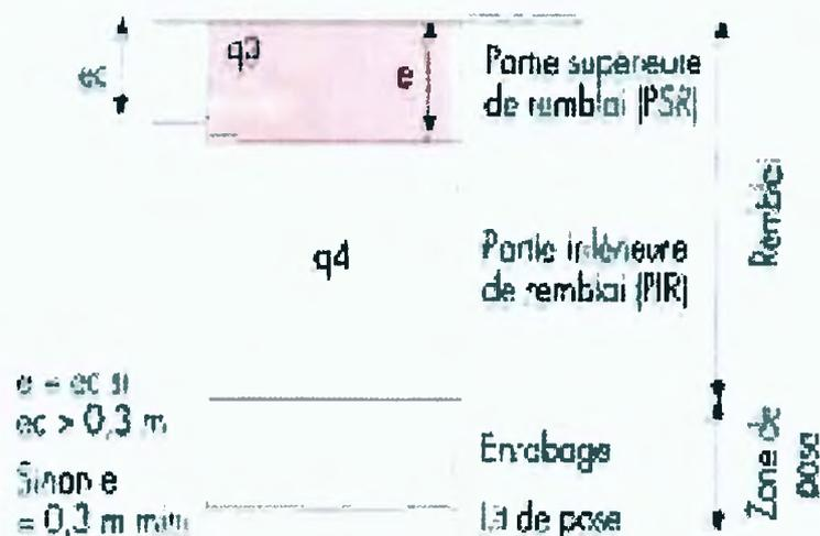
La partie supérieure de remblai est réalisée avec un objectif  $q3$  sur une épaisseur  $e$  égale à celle de la chaussée ( $ec$ ) mais toujours avec un  $min$  de  $0,3 \text{ m}$ . Les conditions relatives à l'enrobage et à la partie inférieure de remblai ( $q4$ ) sont applicables.
