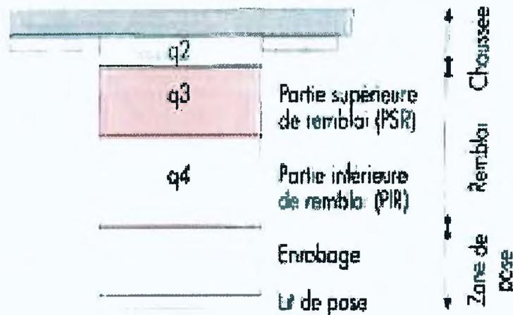
L'épaisseur de la structure de chaussée, dans l'hypothèse où elle est refaite à l'identique, est majorée de 10 % du fait de l'impossibilité de la rendre aussi compacte que la chaussée existante.
