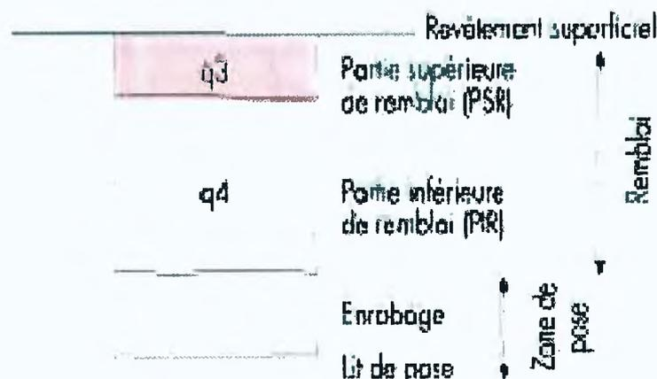
La structure du trottoir compacte pour trottoir non revêtu au minimum 0,15 m de grave bien graduée de bonne portance compactée avec un objectif de densification q3, pour trottoir revêtu d'une reconstruction à l'identique.
