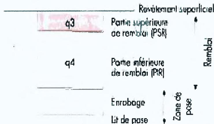
La structure du trottoir compactée pour trottoir non revêtu au minimum 0,15 m de grave bien graduée de bonne portance compactée avec un objectif de densification q3, pour trottoir revêtu d'une reconstruction à l'identique.
