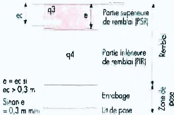
La partie supérieure de remblai est réalisée avec un objectif  $q3$  sur une épaisseur ( $e$ ) égale à celle de la chaussée ( $ec$ ) mais toujours avec un  $\text{min}$  de  $0,3 \text{ m}$ . Les conditions relatives à l'enrobage et à la partie inférieure de remblai ( $q4$ ) sont applicables.
