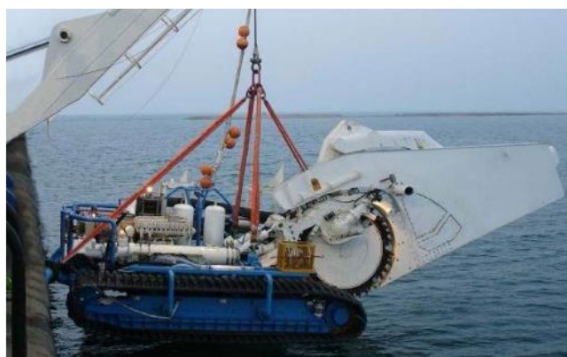
Trancheuse mécanique à roue (Crédit photo Rte)
