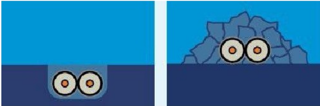
Coupe schématique d'un ensouillage (à gauche) et d'une protection externe (à droite) d'une liaison sous-marine.
