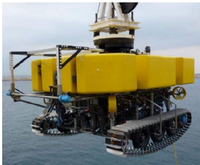
Engin de water-jetting (Crédit photo Rte)
