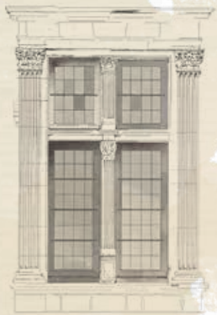
les fenêtres à meneaux
