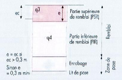
La partie supérieure de remblai est réalisée avec un abjectif q3 sur une épaisseur (e) égale à celle de la chaussée (ec) mais toujours avec un mini de 0,3 m. Les conditions relatives à l'enrobage et à la partie inférieure de remblai (q4) sant applicables.
