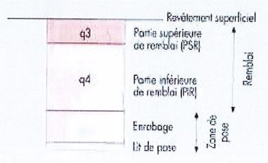
La structure du tratair comparte pour trattair non revêtu au minimum 0,15 m de grave bien graduée de banne portance compactée avec un abjectif de densification q3, paur trattair revêtu d'une reconstrucțion à l'identique.
