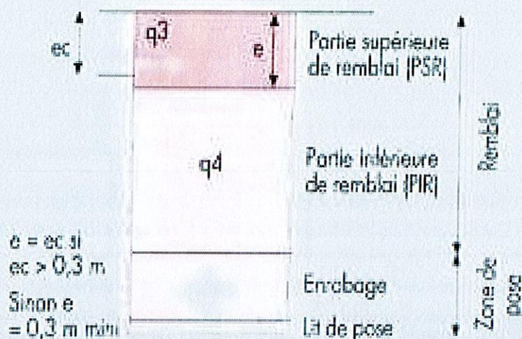
La partie supérieure de remblai est réalisée avec un objectif  $q_3$  sur une épaisseur  $e$  égale à celle de la chaussée  $(ec)$  mais toujours avec un mini de  $0,3 \text{ m}$ . Les conditions relatives à l'enrobage et à la partie inférieure de remblai  $(q_4)$  sont applicables.
