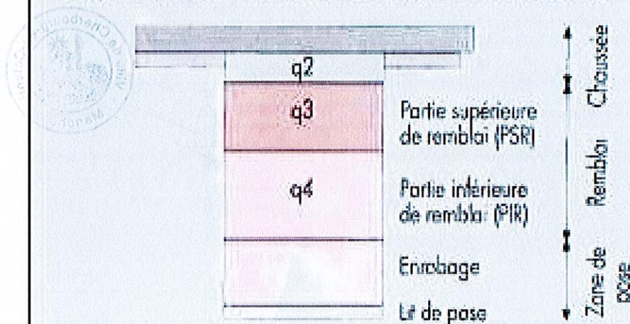
L'épaisseur de la structure de chaussée, dans l'hypothèse où elle est refaite à l'identique, est majorée de 10 % du fait de l'impossibilité de la rendre aussi compacte que la chaussée existante.
