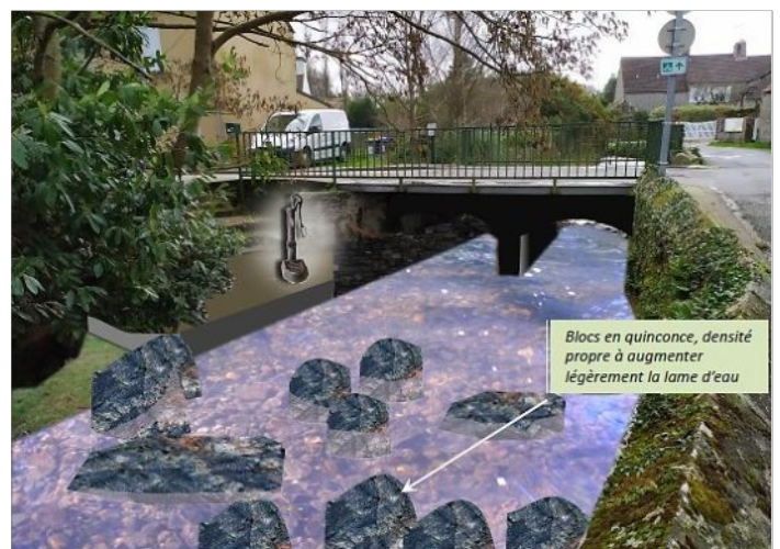
Figure 4: Retrait du seuil, diversification des écoulements, création de caches piscicoles, enfouissement d'un puisard et installation d'une pompe à main
