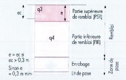
La partie supérieure de remblai est réalisée avec un abjectif q3 sur une épaisseur (e) égale à celle de la chaussée (ec) mais toujours avec un mini de 0,3 m. Les conditions relatives à l'enrobage et à la partie inférieure de remblai (q4) sont applicables.
