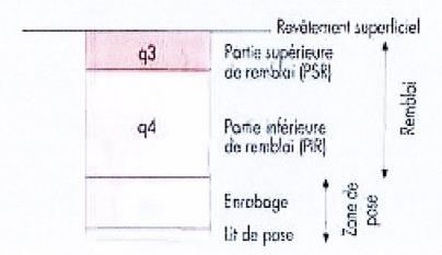
La structure du trettair comparte pour trattair non revêtu au minimum 0,15 m de grave bien graduée de banne portance compactée avec un objectif de densification q3, pour trattair revêtu d'une reconstrucțion à l'identique.
