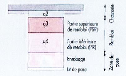
L'épaisseur de la structure de chaussée, dans l'hypothèse au elle est refaite à l'identique, est majarèe de 10 % du fait de l'impossibilité de la rendre aussi compacte que la chaussée existante.
