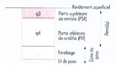
La structure du trestoir comparte pour trattair non revêtu au minimum 0,15 m de grave bien graduée de banne portance compactée avec un objectif de densification q3, pour trattair revêtu d'une reconstrucțion à l'identique.
