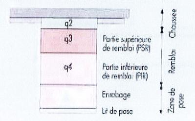
L'épaisseur de la structure de chaussée, dans l'hypothèse au elle est refaite à l'identique, est majarée de 10 % du fait de l'impossibilité de la rendre aussi compacte que la chaussée existante.
