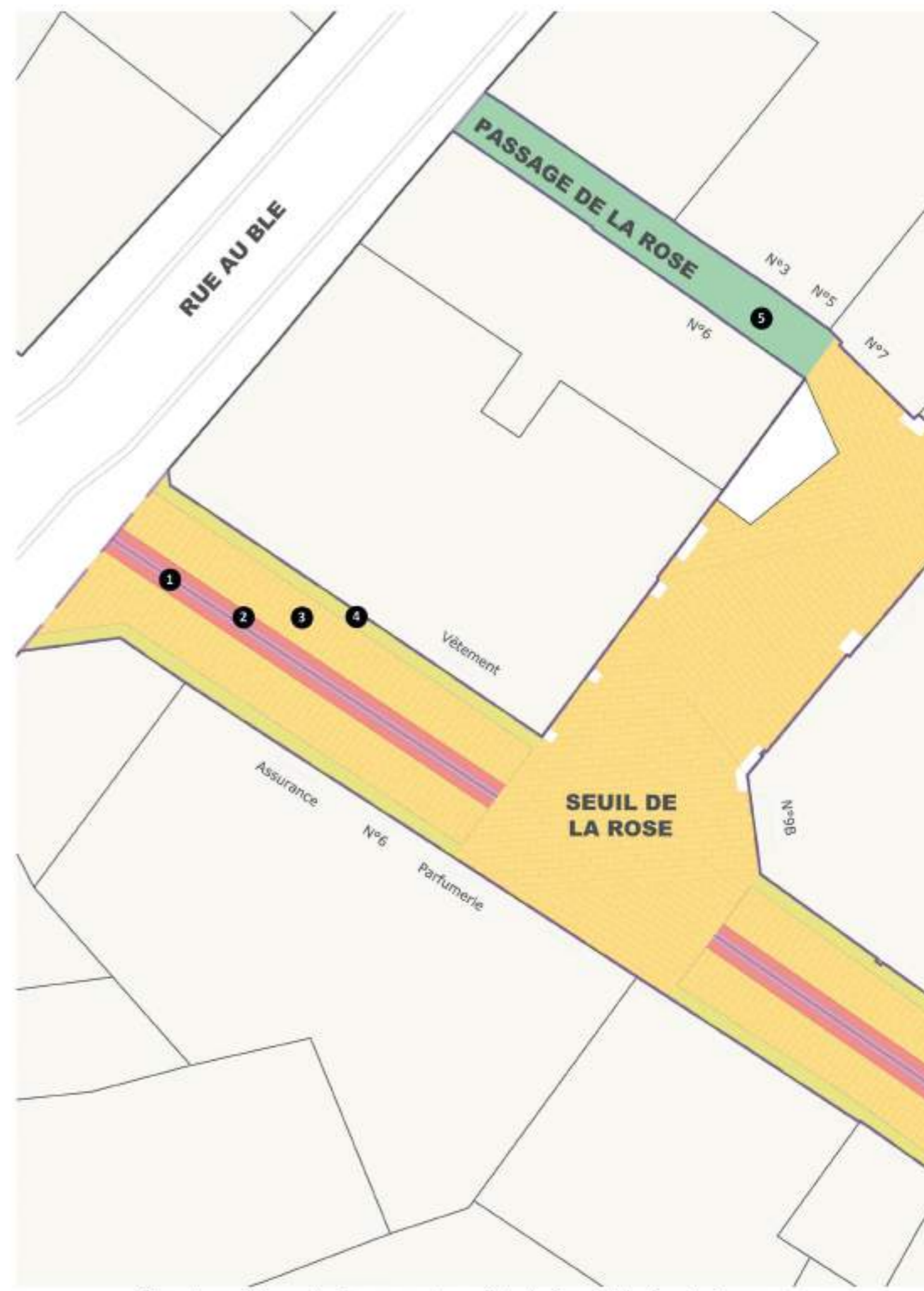
Plan de revêtement - Zoom sur le seuil de la Rose et la Rue du Commerce
